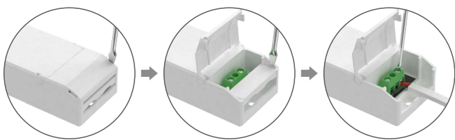
1. 在侧板处使用螺丝批撬起保护盖，并撬起压线板将其拆下后，按照接线图进行接线。
