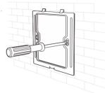
⑤倾斜面板并扣合在底板上,用KM2螺丝 从面板底部将底板锁紧。
